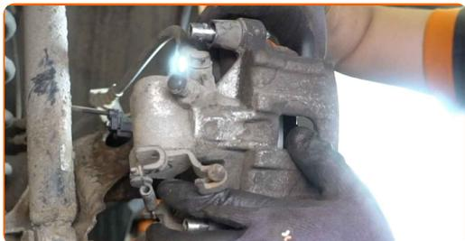
**29** Serra gli elementi di fissaggio della pinza del freno. Usa una chiave HEX N.H7. Usa una chiave dinamometrica. Serralo fino alla coppia di torsione di 28 Nm.
