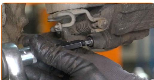
**30** Montare i tappi dei parapolvere delle guide pinza freno.
