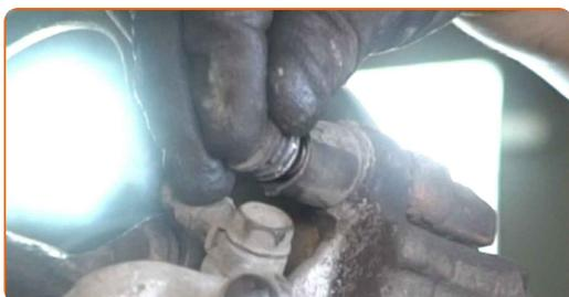
**31** Installare la molla di fissaggio della pinza freno.
