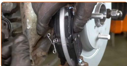
**28** Montare la pinza del freno e fissarla.
