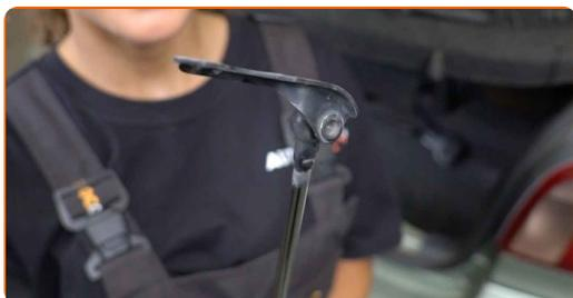
**6** Pulire le sedi di montaggio del pistone portellone. Usare una spazzola pulente in nylon. Usa lo spray WD-40.
