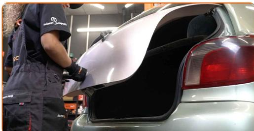
**2** Sostieni il cofano posteriore. Usa un cric idraulico per trasmissione.
