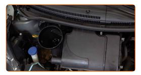
Versa l'olio nel motore attraverso serbatoio. Quantità di olio richiesta:3.5 l.
