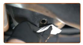
Avvita il nuovo tappo di drenaggio e stringerlo. Utilizza una chiave combinata N°14. Usa una chiave dinamometrica. Serralo fino allo coppia di torsione di 25 Nm.
