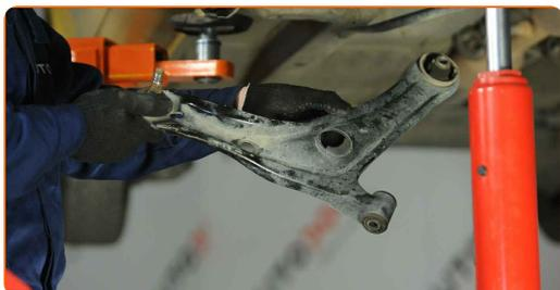
**16** Pulisci le sedi di montaggio e la filettatura del braccio di sospensione. Usa una spazzola metallica. Usa lo spray WD-40.
