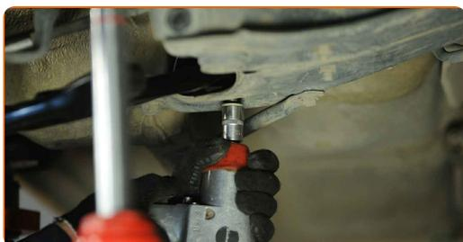
**19** Avvita l'elemento di fissaggio anteriore del braccio. Utilizza una chiave a bussola N°17. Usa una chiave a cricchetto. Usa un giramaschi.
