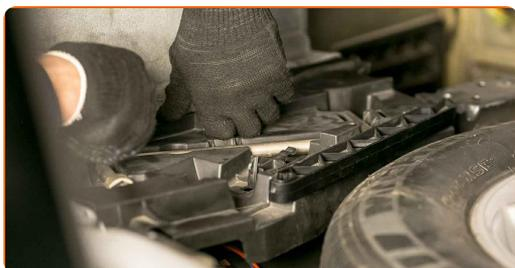
**21** Rimuovi il coperchio di protezione del supporto di ammortizzazione. Usa un giravite piatto.
