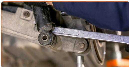
**10** Smonta la parte inferiore dell'ammortizzatore. Usa un piede di porco.
