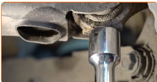
**42** Collega la parte inferiore dell'ammortizzatore.
