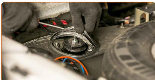
**22** Pulisci l'elemento di fissaggio dell'asta dell'ammortizzatore. Usa una spazzola metallica. Usa lo spray WD-40.
