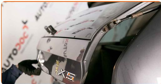
**14** Rimuovi la parte anteriore del rivestimento inferiore del cofano.
