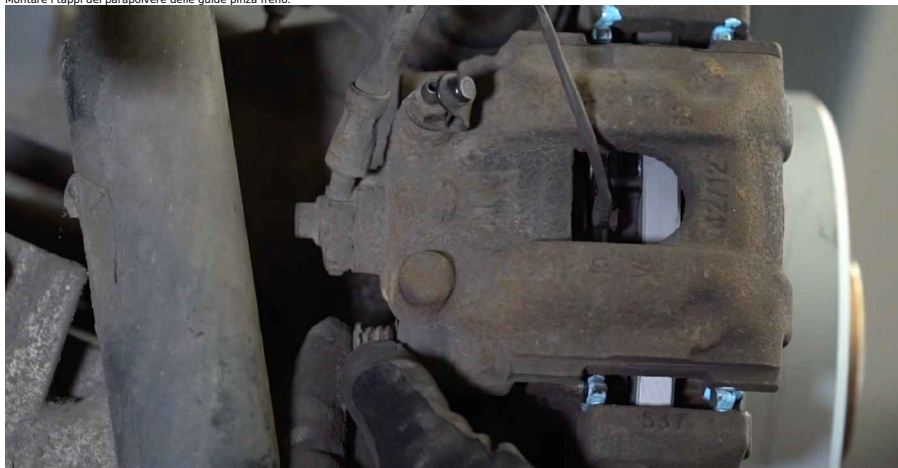
24 Installare la molla di fissaggio della pinza freno.
