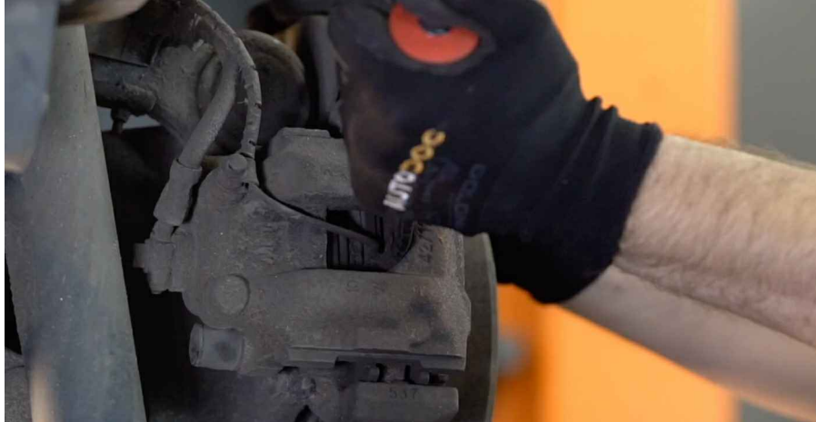
11 Rimuovere i tappi dei parapolvere delle guide pinza freno. Usa un piede di porco.
