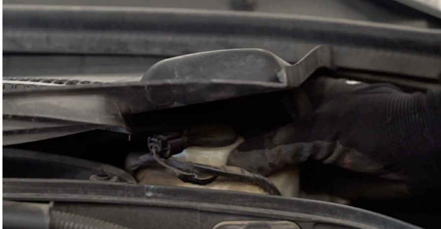
31 Installare il pannello di protezione.
