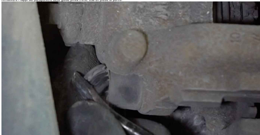
12 Svitare l'attacco della pinza freno. Usa una chiave HEX N.H7. Usa una chiave a cricchetto.
