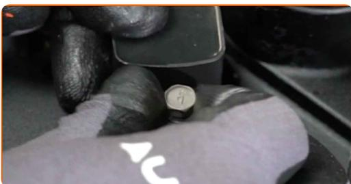
**14** Serrare i dispositivi di fissaggio della bobina di accensione. Utilizza una chiave a bussola N°10. Usa una chiave dinamometrica. Serralo fino allo coppia di torsione di 9 Nm.
