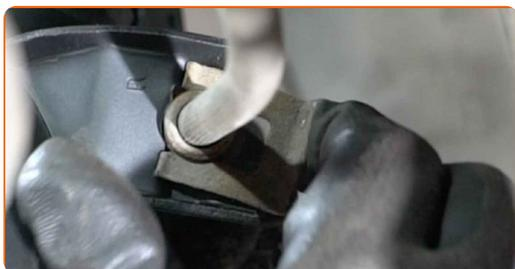
**46** Rimuovere il supporto da sotto il fuso a snodo posteriore.
