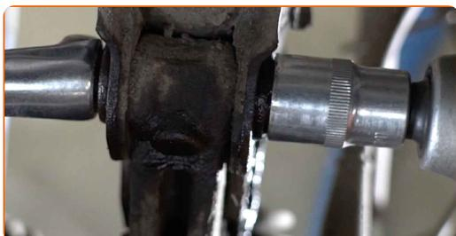
**18** Sorreggere il fuso a snodo posteriore. Usa un cric idraulico per trasmissione.
