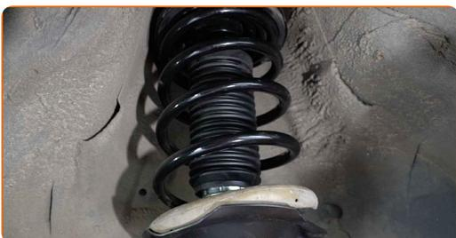
**40** Fissare l'ammortizzatore al fuso a snodo posteriore.
