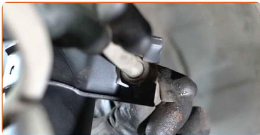
**45** Installa la clip di fissaggio del tubo flessibile del freno. Usa un martello.
