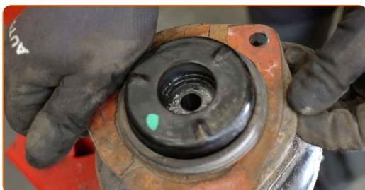
**28** Rimuovi il parapolvere e il paracolpi dell'ammortizzatore.
