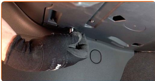
**15** Installa la copertura in plastica laterale. Posiziona il pezzo usando le guide e serra gli elementi di fissaggio.
