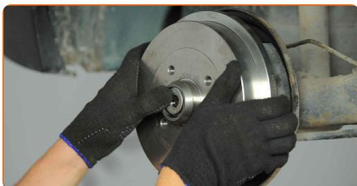
**26** Avvitare l'elemento di fissaggio del mozzo della ruota. Utilizza una chiave combinata N°24.
