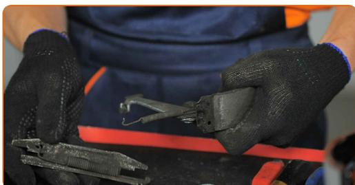
**18** Monta le molle di arresto superiori e il meccanismo di regolazione sulle nuove ganasce del freno. Usa delle pinze.
