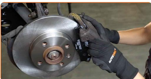
**19** Montare i tappi dei parapolvere delle guide pinza freno.
