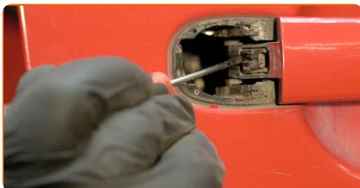
Sostituzione: serratura porta - VW Transporter VI Van (SGA, SGH). Il consiglio di AUTODOC:
