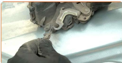
**Sostituzione: serratura porta - VW Transporter VI Van (SGA, SGH). AUTODOC raccomanda:**
