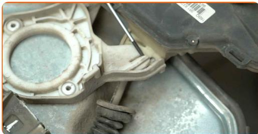
**30** Installare il cavo del blocco-maniglia.
