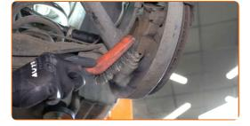
Avvita l'elemento di fissaggio inferiore dell'ammortizzatore. Utilizza una chiave combinata N°21. Utilizza una chiave a bussola N°21. Usa una chiave a cricchetto.
