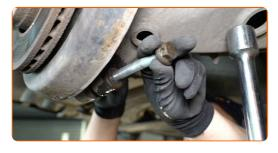
Svita l'elemento di fissaggio superiore dell'ammortizzatore. Utilizza una chiave a bussola N°18. Usa una chiave a cricchetto.
