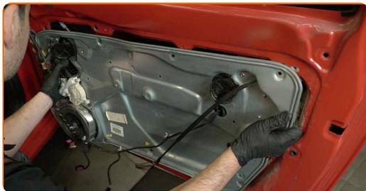
Sostituzione: serratura porta - VW Transporter VI Camion pianale / Telaio (SFD, SFE, SFL, SFZ). AUTODOC raccomanda:
