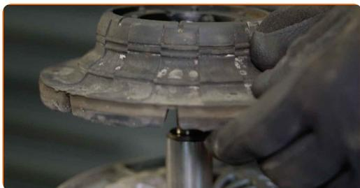
**42** Rimuovi il parapolvere e il paracolpi dell'ammortizzatore.
