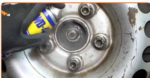
**15** Allenta l'elemento di fissaggio dell'albero di trasmissione. Utilizza una chiave a bussola N°30. Usa un giramaschi.
