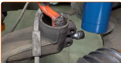
**59** Fissare il supporto di ammortizzazione sul fuso a snodo.
