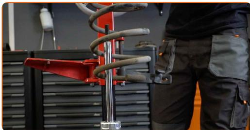
**45** Rimuovi l'ammortizzatore vecchio dal compressore idraulico per molle ammortizzatori.
