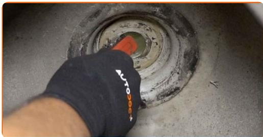
**56** Installare il supporto di ammortizzazione nell'arco passaruota.
