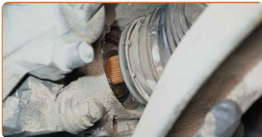
**64** Rimuovi il supporto da sotto il fuso a snodo.
