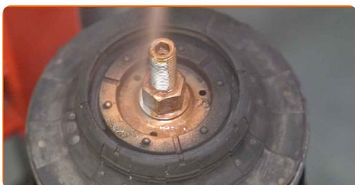
**55** Pulisci le sedi di montaggio del puntone dell'ammortizzatore. Usa una spazzola metallica. Usa lo spray WD-40.
