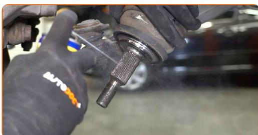
**63** Montare l'albero di trasmissione.
