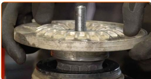
**51** Serrare la vite dell'asta pistone supporto ammortizzazione. Utilizza una chiave a bussola N°21. Usa una chiave HEX N.H7. Usa una chiave dinamometrica. Serralo fino allo coppia di torsione di 80 Nm.
