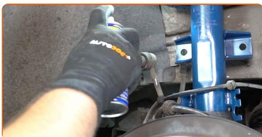
**70** Installa il puntone stabilizzatore trasversale.
