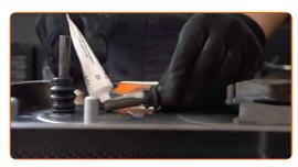
Installare i perni di guida della pinza del freno.
