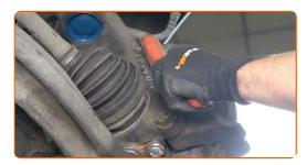
Svitare gli elementi di fissaggio del supporto della pinza del freno. Utilizza una chiave a bussola N°21. Usa una chiave a cricchetto. Usa un giramaschi.
