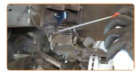
Premere il pistone della pinza freno. Usa un arretratore per pistoncini freni a disco.
