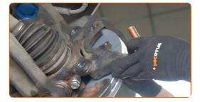
27 Monta i bulloni di fissaggio (2 pezzi).
