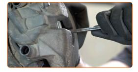
Svitare gli elementi di fissaggio della pinza del freno. Usa una chiave HEX N.H7. Usa una chiave a cricchetto.
