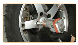
Rimettere il veicolo per terra e, lavorando in ordine incrociato, serrare i bulloni di fissaggio delle ruote. Usa la chiave a bussola per dadi cerchio ruota n.19. Usa una chiave dinamometrica. Serralo fino allo coppia di torsione di 180 Nm.
