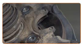
Pulire l'elemento di fissaggio del disco del freno. Usa una spazzola metallica. Usa lo spray WD-40.
