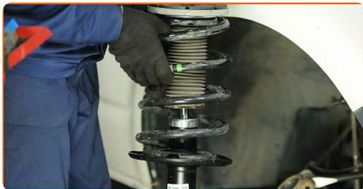
**62** Avvitare i fissaggi superiori del supporto del puntone di sospensione.
