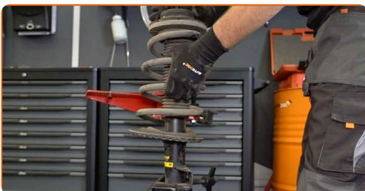
Sostituzione: ammortizzatore a molla - VW Transporter V Bus (7HB, 7HJ, 7EB, 7EJ, 7EF, 7EG, 7HF, 7EC). Il consiglio di AUTODOC:
