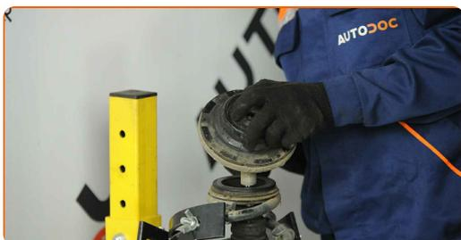
**47** Rimuovi il parapolvere e il paracolpi dell'ammortizzatore.
