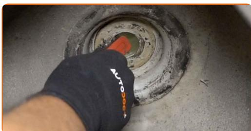
**61** Installare il supporto di ammortizzazione nell'arco passaruota.
