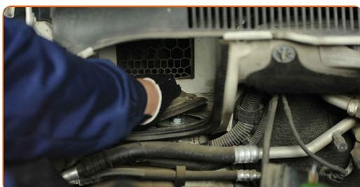
**39** Pulire l'elemento di fissaggio superiore del supporto del puntone di sospensione. Usa una spazzola metallica. Usa lo spray WD-40.
