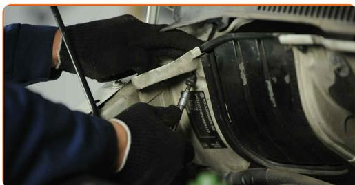
**67** Installa la guarnizione griglia sottoparabrezza.
