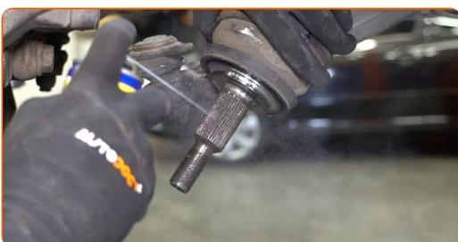
**82** Installare il fuso a snodo dello sterzo sull'assale CV.
