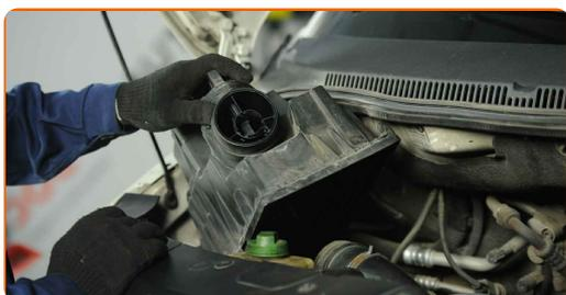
**70** Collega il tubo di aspirazione dell'aria all'alloggiamento del filtro dell'aria.
