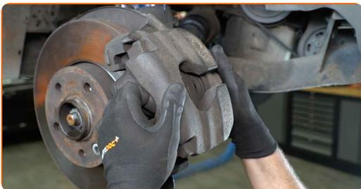
Sostituzione: dischi freni - VW Transporter V Bus (7HB, 7HJ, 7EB, 7EJ, 7EF, 7EG, 7HF, 7EC). I professionisti raccomandano:
