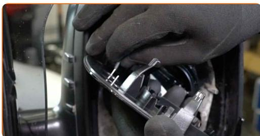
**8** Installare il nuovo vetro dello specchietto. Assicurati di sentire un clic indicante che si trova installato saldamente.
