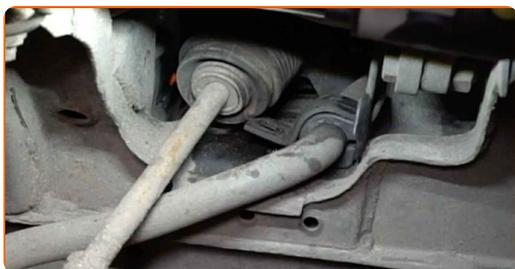
**13** Avvita le staffe di supporto della boccola dello stabilizzatore. Utilizza una chiave a bussola N°16. Usa una chiave dinamometrica. Serralo fino alla coppia di torsione di 45 Nm.
