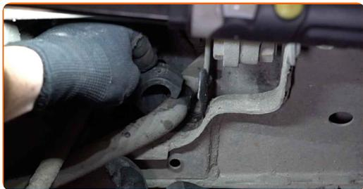
**12** Installa le staffe di supporto della boccola dello stabilizzatore. Usa un piede di porco.
