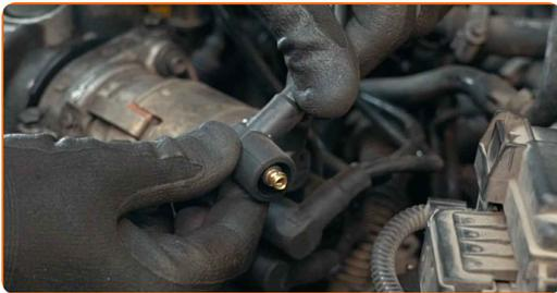
Sostituzione: cavi candele - VW Transporter T4 Camion pianale / Telaio (70E, 70L, 70M, 7DE, 7DL, 7D). Consiglio:
