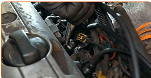
Sostituzione: cavi candele - VW Transporter T4 Camion pianale / Telaio (70E, 70L, 70M, 7DE, 7DL, 7D). Gli esperti di AUTODOC raccomandano:
