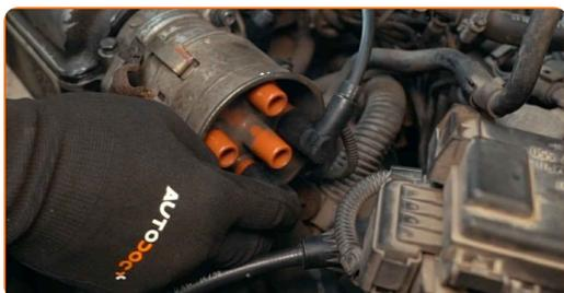
Sostituzione: cavi candele - VW Transporter T4 Camion pianale / Telaio (70E, 70L, 70M, 7DE, 7DL, 7D). AUTODOC raccomanda:
