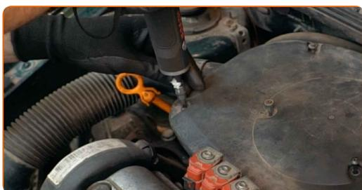
**4** Rimuovere l'alloggiamento del filtro dell'aria.
