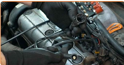
Sostituzione: cavi candele - VW Transporter T4 Camion pianale / Telaio (70E, 70L, 70M, 7DE, 7DL, 7D). Il consiglio degli esperti di AUTODOC:
