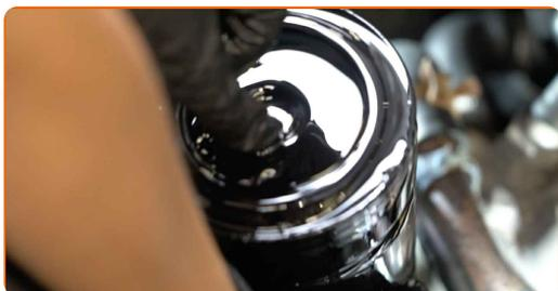
Sostituzione: olio motore e filtro - VW Transporter T3 Camion pianale/Telaio.
