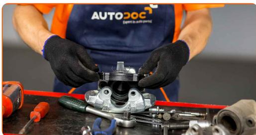
**17** Montare la pinza del freno e fissarla.
