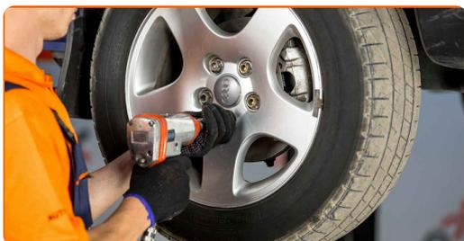
Sostituzione: pinza de freno - VW Transporter IV Van (70A, 70H, 7DA, 7DH).
