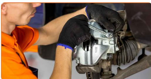
**26** Installare la molla di fissaggio della pinza freno. Usa un giravite piatto.
