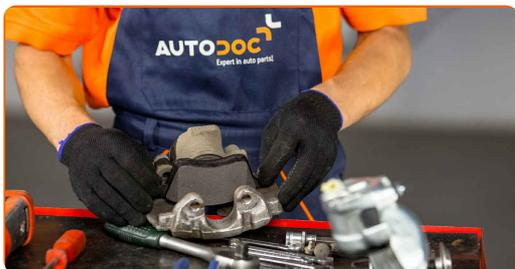
Sostituzione: pinza de freno - VW Transporter IV Camion pianale / Telaio (70E, 70L, 70M, 7DE, 7DL). I professionisti raccomandano:
