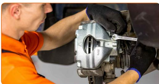
**24** Spurgare la pinza del freno. Senza avviare il motore, premere il pedale del freno più volte finché non viene percepita una resistenza significativa.
