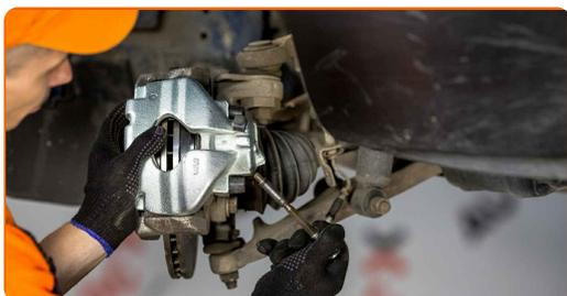
Sostituzione: pinza de freno - VW Transporter IV Camion pianale / Telaio (70E, 70L, 70M, 7DE, 7DL). Il consiglio di AUTODOC:
