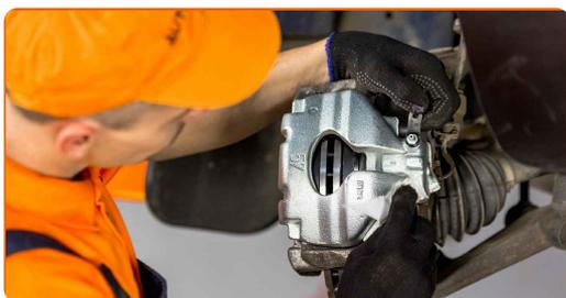
**25** Serra la vite di spurgo della pinza freno. Utilizza una chiave combinata N°11. Usa una chiave dinamometrica. Serralo fino allo coppia di torsione di 10 Nm.
