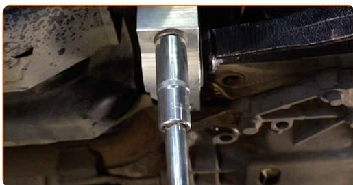
**23** Avvita gli elementi di fissaggio posteriori che collegano il braccio di sospensione al sottotelaio. Utilizza una chiave a bussola N°16. Usa una chiave a cricchetto.
