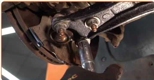
**25** Stringi gli elementi di fissaggio del giunto sferico. Utilizza una chiave a bussola N°16. Usa una chiave dinamometrica. Serralo fino allo coppia di torsione di 60 Nm.
