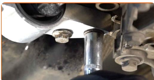
**24** Avvita gli elementi di fissaggio del giunto sferico. Utilizza una chiave a bussola N°16. Usa una chiave a cricchetto.
