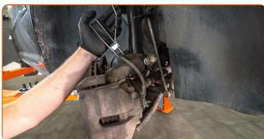
**11.2** Svitare il tubo flessibile del freno dalla pinza del freno. Utilizza una chiave a bussola N°11. Usa una chiave a cricchetto. Metti da parte il tubo flessibile del freno. Lega il tubo flessibile del freno alla carrozzeria dell'auto con un gancio o un pezzo di filo.
