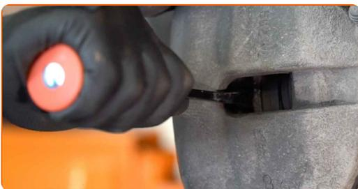
**14** Per mezzo di un cacciavite di tipo spaccato estrarre la molla di fissaggio della pinza.
