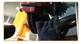
Serrare il dado di fissaggio del giunto sferico. Utilizza una chiave a bussola N°16. Usa una chiave dinamometrica. Serralo fino allo coppia di torsione di 60 Nm.
