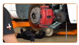
Installa l'albero di trasmissione all'interno del mozzo della ruota.
