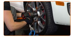
Allenta il bullone del mozzo della ruota. Usa una chiave a bussola 12 punte n. 24. Usa un giramaschi.
