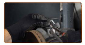
Pulisci gli elementi di fissaggio che collegano il puntone stabilizzatore al puntone dell'ammortizzatore, e quelli che collegano il puntone dell'ammortizzatore al fuso a snodo. Usa una spazzola metallica. Usa lo spray WD-40.
