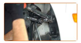
Collega gli elementi di fissaggio del cavo sensore ABS ai supporti di ammortizzazione. Fissare sul montante il tubo dell'impianto freni.
