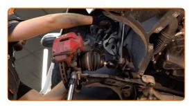
Abbassa il cric per trasmissione idraulica di 10-15 cm.
