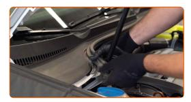
Allenta gli elementi di fiìssaggio superiori del supporto dell'ammortizzatore. Utilizza una chiave a bussola N°13. Usa una chiave a cricchetto.
