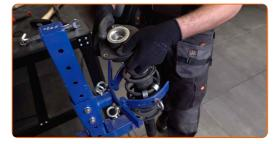
Installa il nuovo supporto, il parapolvere e il tampone dell'ammortizzatore.
