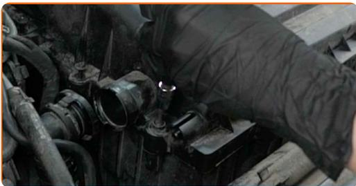
**14** Collegare il tubo del vuoto all'alloggiamento del filtro dell'aria.
