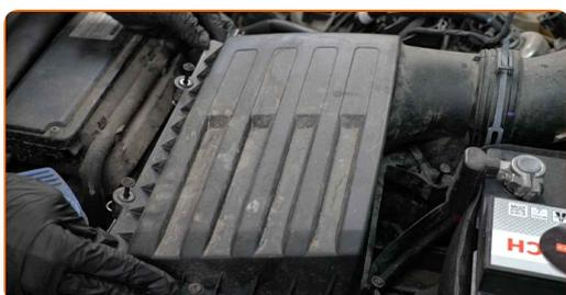
**13** Avvita le viti di serraggio sul coperchio del filtro dell'aria. Usa la chiave Torx T 25. Usa una chiave a cricchetto.
