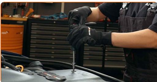
**17** Rimuovi la copertura di protezione del parafrangente.
