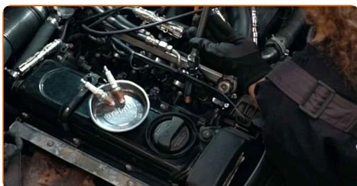
**11** Avvitare le nuove candele e serrarle. Usa la chiave a bussola per candele numero 16. Usa una chiave dinamometrica. Serralo fino allo coppia di torsione di 25 Nm.
