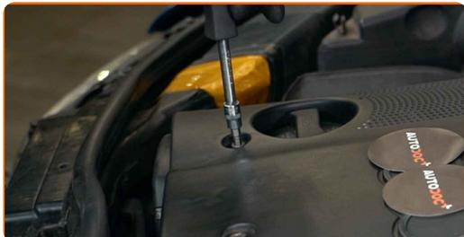
**4** Rimuovere la copertura del motore.
