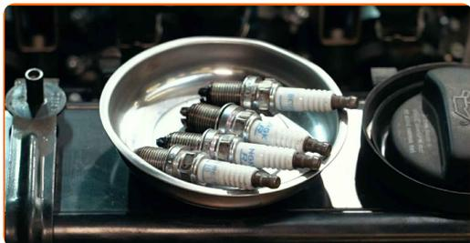
**9** Applica uno strato sottile dello speciale lubrificante antigrippaggio per alte temperature alle filettature delle candele nuove.
