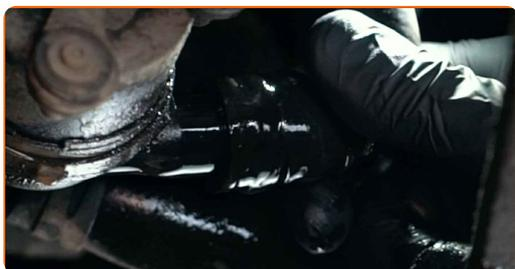
23 Fissare il morsetto del tubo di raffreddamento. Usa le pinze per fascette Clic-R.
