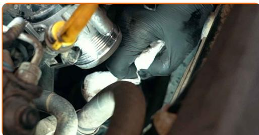
58 Pulire la sede di montaggio del tubo flessibile di aspirazione dell'aria. Usa un detergente spray multiuso.
