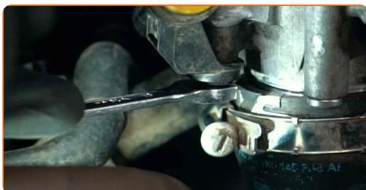
61 Tieni saldamente gli elementi di fissaggio del condotto d'immissione dell'aria. Utilizza una chiave a bussola N°7. Usa una chiave a cricchetto.
