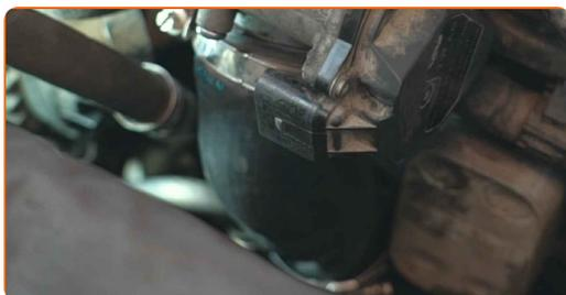
60 Avvitare l'elemento di fissaggio del tubo dell'asta di livello. Utilizza una chiave combinata N°10.
