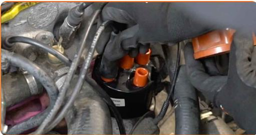
Sostituzione: spazzola rotante spinterogeno - VW Scirocco II (53B). AUTODOC raccomanda:
