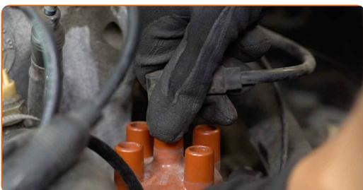
Sostituzione: spazzola rotante spinterogeno - VW Scirocco II (53B). Il consiglio di AUTODOC:
