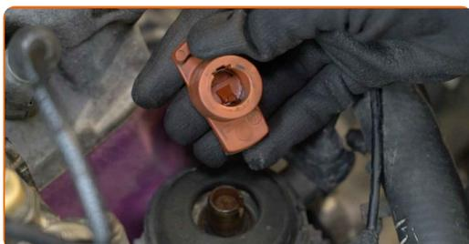
Sostituzione: spazzola rotante spinterogeno - VW Scirocco II (53B). I professionisti raccomandano:
