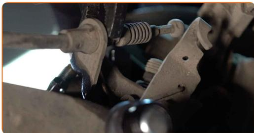
**13** Scollegare il cavo freno di stazionamento dalla pinza. Usa le pinze per pompa ad acqua.
