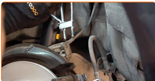
**27** Installa il cavo del freno di stazionamento nella staffa della pinza del freno. Usa le pinze per pompa ad acqua.
