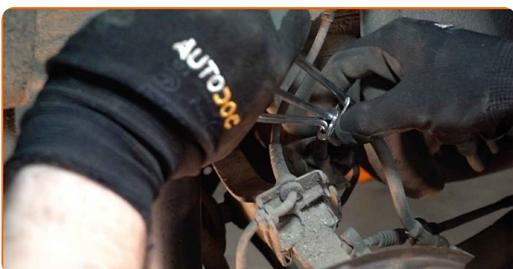
**8** Metti un contenitore per la raccolta del fluido freni al di sotto.
