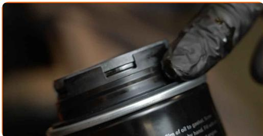
**15** Avvitare il nuovo filtro nella posizione di lavoro. Usa la bussola 76-14F. Usa una chiave dinamometrica. Serralo fino allo coppia di torsione di 25 Nm.
