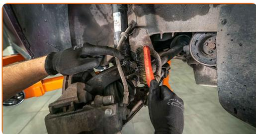
**13** Svita gli elementi di fissaggio che collegano il giunto sferico al braccio di sospensione. Utilizza una chiave a bussola N°13.
