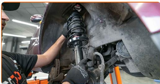
**33** Serrare il fissaggio superiore del supporto di ammortizzazione.
