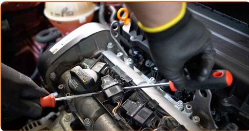
8 Togli la bobina di accensione dall'alloggiamento della candela. Usa un estraattore per bobine di accensione.
