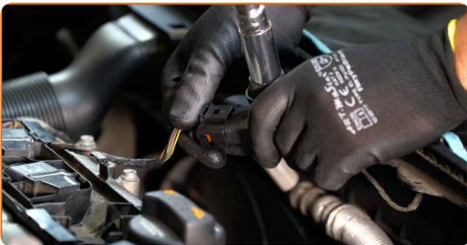
**13** Installa la nuova bobina di accensione all'alloggiamento della candela. Assicurati di sentire un clic indicante che si trova installato saldamente.
