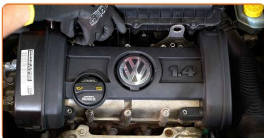
5 Rimuovere la copertura del motore. Usa la chiave Torx T 30.
