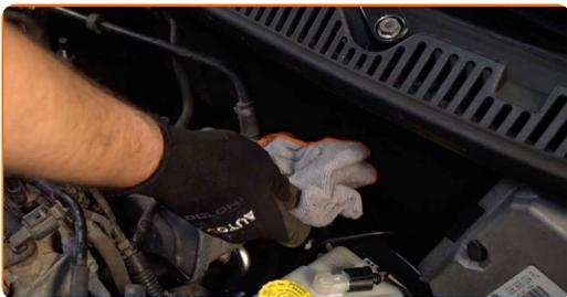
**27** Montare il coperchio motore e fissarlo. Assicurati di sentire un clic indicante che si trova installato saldamente.
