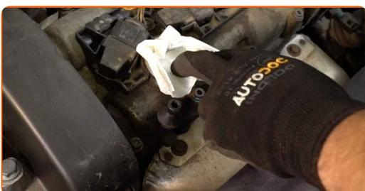
**10** Allenta i fermi di bloccaggio del connettore della bobina di accensione. Usa un giravite piatto.
