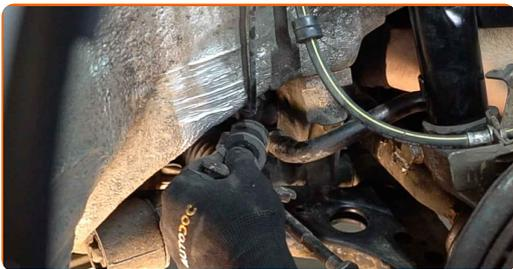
**13** Installa le nuove boccole dello stabilizzatore.
