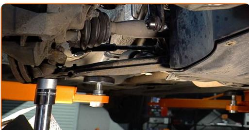
**16** Monta i bulloni di fissaggio (2 pezzi). Usa un piede di porco.
