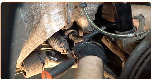
**12** Rimuovi le boccole dello stabilizzatore.
