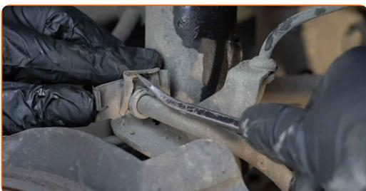
**18** Scollegare il cablaggio del sensore ABS.
