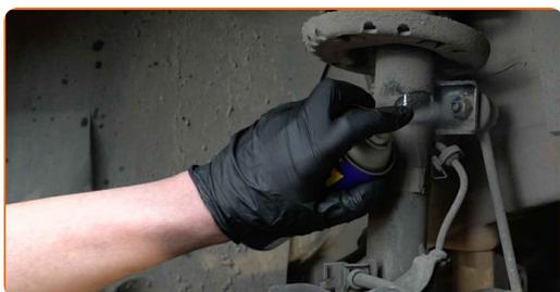
**13** Svita gli elementi di fissaggio che collegano il tirante della barra stabilizzatrice al puntone dell'ammortizzatore. Utilizza una chiave a bussola N°17. Usa una chiave a cricchetto.
