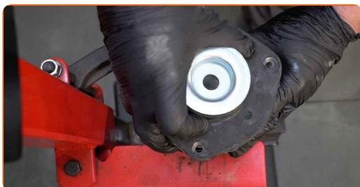
**42** Serrare la vite dell'asta pistone supporto ammortizzazione. Usa una chiave HEX N.H7. Utilizza una chiave a bussola N°21. Usa una chiave dinamometrica. Serralo fino allo coppia di torsione di 60 Nm.
