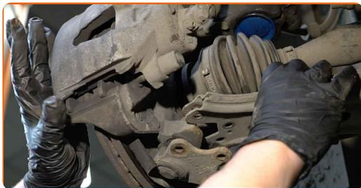
**56** Avvita gli elementi di fissaggio del giunto sferico. Utilizza una chiave a bussola N°13. Usa una chiave a cricchetto.
