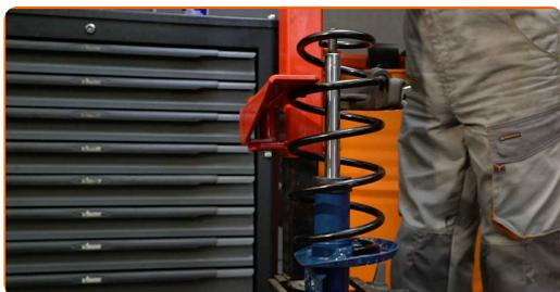
**41** Installa il nuovo supporto, il parapolvere e il tampone dell'ammortizzatore.
