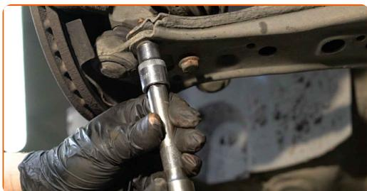
**57** Stringi gli elementi di fissaggio del giunto sferico. Utilizza una chiave a bussola N°13. Usa una chiave dinamometrica. Serralo fino alla coppia di torsione di 20 Nm. +90°
