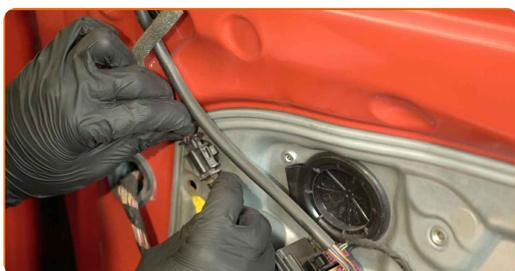
**20** Scollegare il cablaggio dalla copertura protettiva dello sportello. Usa uno strumento per estrazione clip.
