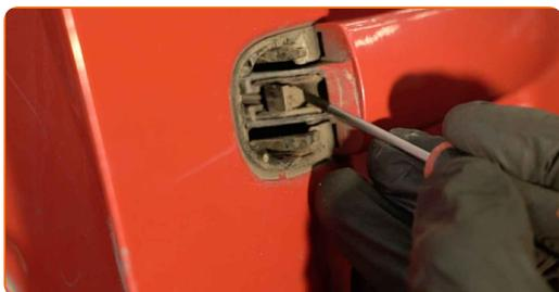
**18** Svitare gli elementi di fissaggio della serratura dello sportello. Usa la chiave XZN n.8. Usa una chiave a cricchetto.
