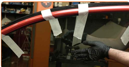
**47** Abbassare il vetro del finestrino e installarlo nella sua sede di montaggio nel meccanismo alzacrystalli.
