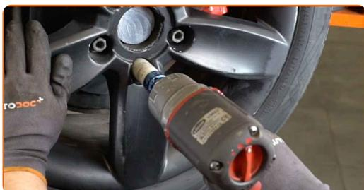
**23** Rimettere il veicolo per terra e, lavorando in ordine incrociato, serrare i bulloni di fissaggio delle ruote. Usa la chiave a bussola per dadi cerchio ruota n.17. Usa una chiave dinamometrica. Serralo fino allo coppia di torsione di 120 Nm.
