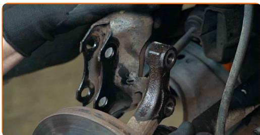
15 Svitare il fissaggio superiore del puntone di sospensione.
