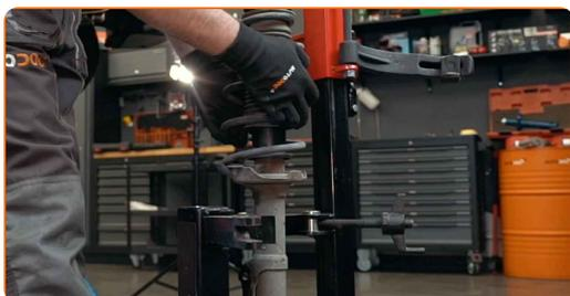
Sostituzione: ammortizzatore a molla - VW Polo III Variant (6V5). Gli esperti di AUTODOC raccomandano:
