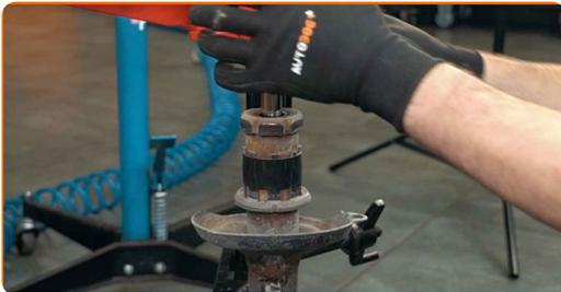
Sostituzione: ammortizzatore a molla - VW Polo III Variant (6V5). Il consiglio degli esperti di AUTODOC:
