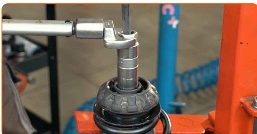
Sostituzione: ammortizzatore a molla - VW Polo III Variant (6V5). I professionisti raccomandano:
