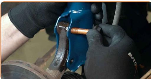
40 Avvitare gli elementi di fissaggio che collegano il puntone di sospensione al fuso a snodo dello sterzo. Utilizza una chiave combinata N°18. Utilizza una chiave a bussola N°18. Usa una chiave a cricchetto.
