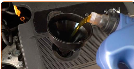
Sostituzione: olio motore e filtro - VW Polo III Van Van / Station Wagon (6V5).
