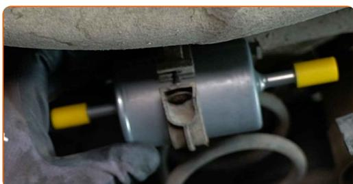
Sostituzione: filtro carburante - VW Polo III Van Van / Station Wagon (6V5). Gli esperti di AUTODOC raccomandano:
