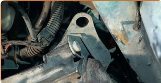
**70** Avvitare gli elementi di fissaggio che collegano il supporto della scatola del cambio alla scatola del cambio. Utilizza una chiave combinata N°16.
