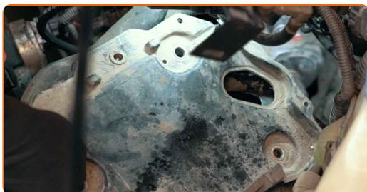
**116** Avvitare gli elementi di fissaggio del vassoio della batteria. Utilizza una chiave a bussola N°10. Usa una chiave a cricchetto.
