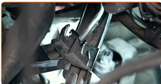
**111** Avvitare l'elemento di fissaggio del cavo di messa a terra. Utilizza una chiave combinata N°13.
