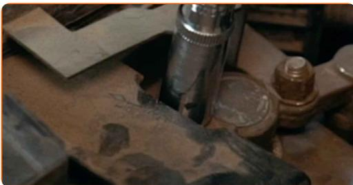
**4** Rimuovi i terminali della batteria.
