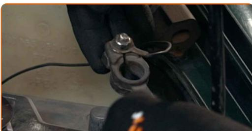
5 Svitare l'elemento di fissaggio della batteria. Utilizza una chiave a bussola N°13. Usa una chiave a cricchetto.
