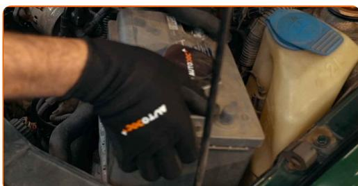
7 Svitare gli elementi di fissaggio del vassoio della batteria. Utilizza una chiave a bussola N°10. Usa una chiave a cricchetto.
