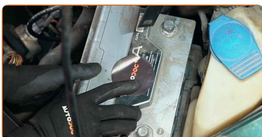
**118** Avvitare l'elemento di fissaggio della batteria. Utilizza una chiave a bussola N°13. Usa una chiave a cricchetto.
