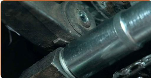
**69** Installare il supporto inferiore della scatola del cambio.
