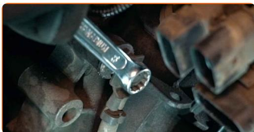
12 Svitare l'elemento di fissaggio del cavo di messa a terra. Utilizza una chiave combinata N°13.
