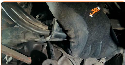
14 Svitare gli elementi di fissaggio del motorino d'avviamento del motore. Utilizza una chiave a bussola N°13. Usa una chiave a cricchetto.
