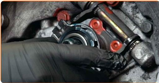
64 Sorreggere il cambio. Usa un cric idraulico per trasmissione.
