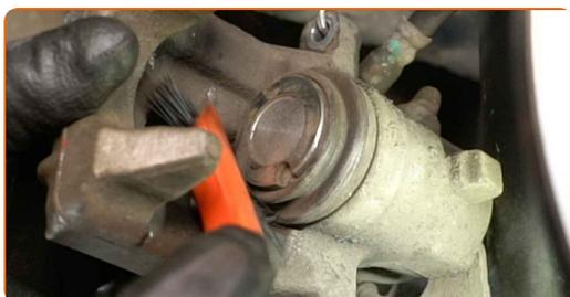
**31** Premere il pistone della pinza del freno. Usa un arretratore per pistoncini freni a disco.
