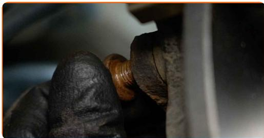
**29** Serrare gli elementi di fissaggio del supporto della pinza del freno. Usa una chiave HEX N.H8. Usa una chiave dinamometrica. Serralo fino allo coppia di torsione di 65 Nm.
