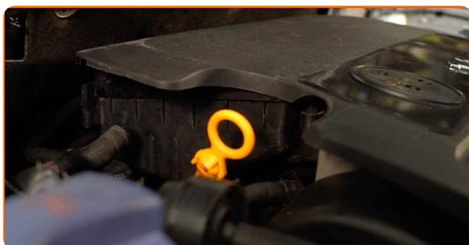
**4** Rimuovere la copertura del motore. L'alloggiamento del filtro aria è integrato nel cofano motore.
