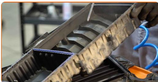
**Sostituzione: filtro aria - VW Polo Hatchback (6R1, 6C1). Consiglio:**
