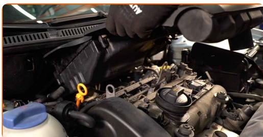
Sostituzione: filtro aria - VW Polo Hatchback (6R1, 6C1). Il consiglio di AUTODOC:
