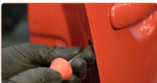
**39** Installare il coperchio sull'elemento di fissaggio della maniglia esterna dello sportello.
