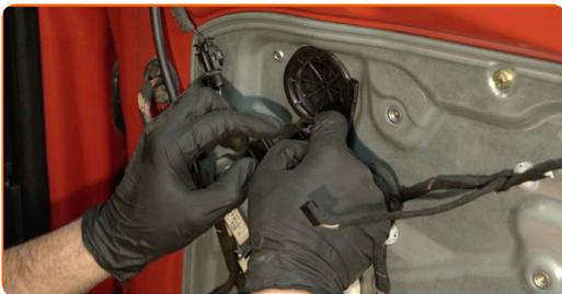
**53** Collegare il cavo dell'attuatore della serratura dello sportello.
