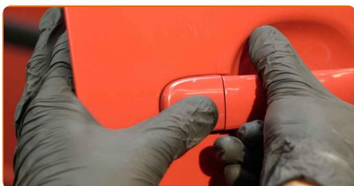
**38** Avvitare l'elemento di fissaggio della maniglia esterna dello sportello. Usa la chiave Torx T20. Usa una chiave a cricchetto.
