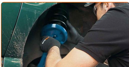
**37** Fissare il supporto di ammortizzazione sul fuso a snodo.
