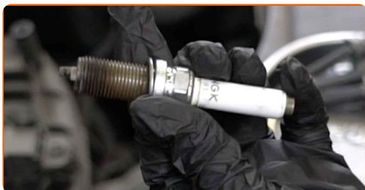
**11** Applica uno strato sottile dello speciale lubrificante antigrippaggio per alte temperature alle filettature delle candele nuove.
