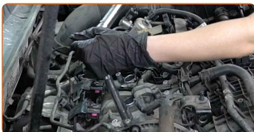
Sostituzione: candele di accensione - VW Passat Variant (3G5, CB5).
