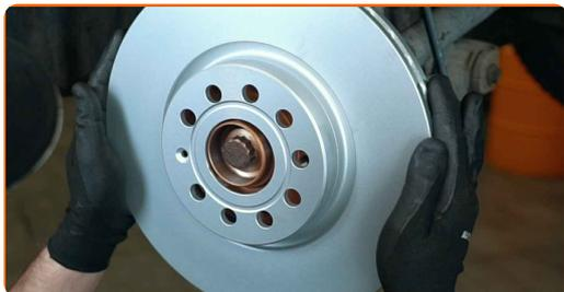
**58** Serrare l'attacco del disco freno. Usa la chiave Torx T30. Usa una chiave dinamometrica. Serralo fino allo coppia di torsione di 4 Nm.
