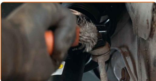
**33** Svita gli elementi di fissaggio che collegano il tirante della barra stabilizzatrice al puntone dell'ammortizzatore. Utilizza una chiave a bussola N°18. Usa una chiave a cricchetto.
