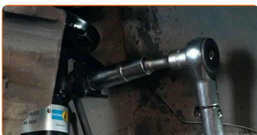
**55** Installa il bullone dell'albero di trasmissione e serralo. Utilizza una chiave a bussola N°27. Usa una chiave a cricchetto.
