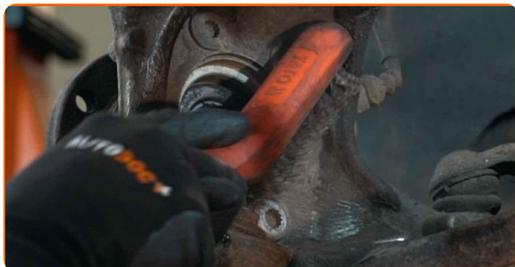
**36** Svitare la staffa di fissaggio del cuscinetto del mozzo della ruota. Usa la chiave XZN n.12. Usa una chiave a cricchetto.
