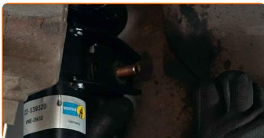
**54** Serra gli elementi di fissaggio che collegano il tirante della barra stabilizzatrice al puntone dell'ammortizzatore. Utilizza una chiave combinata N°18. Utilizza una chiave a bussola N°18. Usa la chiave XZN n.6. Usa una chiave dinamometrica. Serralo fino allo coppia di torsione di 55 Nm.
