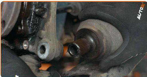
**32** Pulisci i giunti della barra stabilizzatrice. Usa una spazzola metallica. Usa lo spray WD-40.
