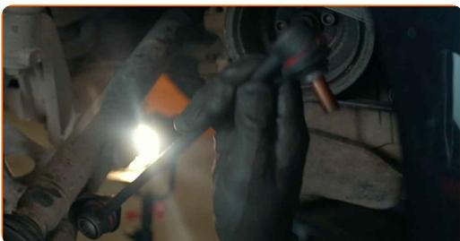
**35** Pulisci gli elementi di fissaggio del cuscinetto del mozzo ruota. Usa una spazzola metallica. Usa lo spray WD-40.
