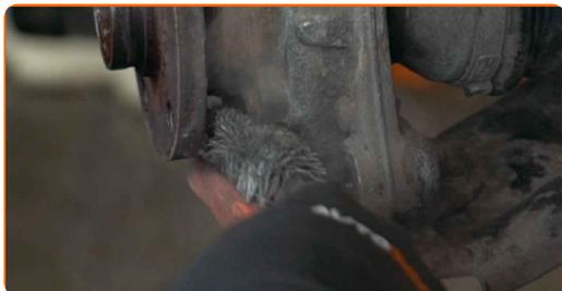
**28** Pulisci gli elementi di fissaggio che collegano il giunto sferico al braccio di controllo della sospensione. Usa una spazzola metallica. Usa lo spray WD-40.
