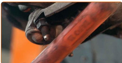
**29** Svita gli elementi di fissaggio che collegano il giunto sferico al braccio di sospensione. Utilizza una chiave a bussola N°16. Usa una chiave a cricchetto.
