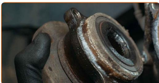
**38** Svita gli elementi di fissaggio del sensore ABS. Usa una chiave HEX N.H5. Usa una chiave a cricchetto.
