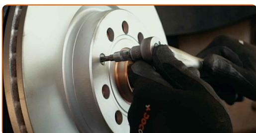
**59** Pulire il sostegno pinza freno da sporco e polvere. Usa una spazzola metallica. Usa un pulitore freni.
